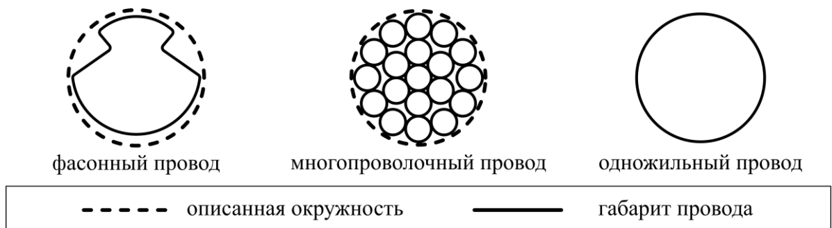
Рисунок 2.7 – Поперечное сечение различных типов проводов, применяемых в контактной сети
